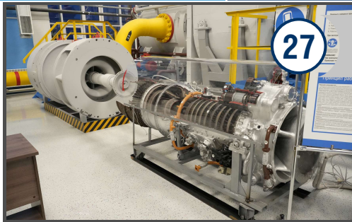
Учебное наглядное пособие «Газотурбинный двигатель АИ-20»
